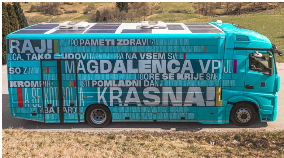
Zadostno število sončnih celic na celotni površini strehe omogoča energetsko samooskrbnost vozila. Foto: Knjižnica Cirila Kosmača Tolmin
