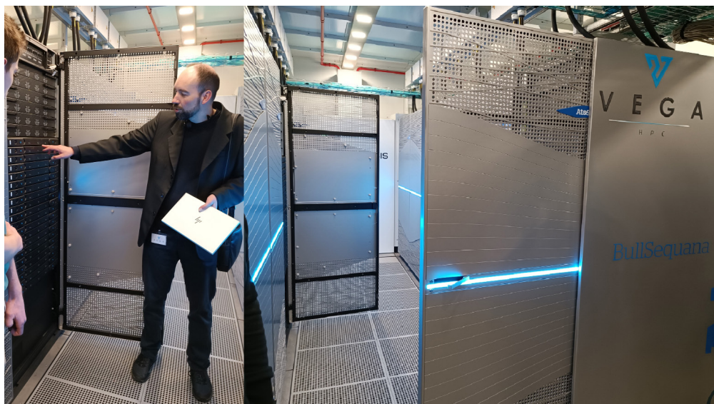
Aleš Zemljak prikazuje rezine v omarah operativnega dela HPC VEGA, ki je vodno hlajen.
